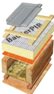
Systemaufbau einer Kombi-Dämmung mit einer neuen Vollsparrendämmung
